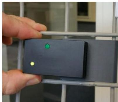
Detektor der Fälschungssicherung am Beispiel der Gitterboxenklammer.
