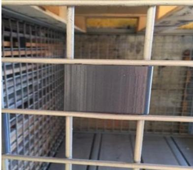
Seit vielen Jahren versucht man diverse Ladungsträger wie Gitterboxen mit RFID-Tags zu versehen, doch egal wie und wo diese befestigt werden hat man entweder ein Problem beim Auslesen, weil die Metallstruktur Störungen verursacht oder mit der Befestigung, weil durch robustes Handling eine schnelle Beschädigung des RFID-Tags hervorgerufen wird.
