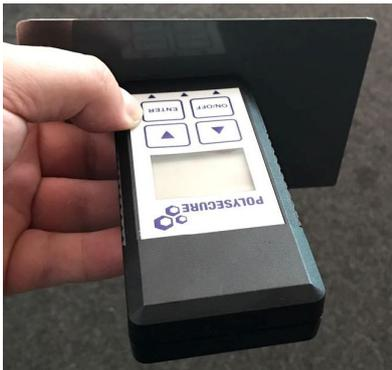
In den meisten Fällen genügt eine Identifikation aber über unsere Detektoren, und zwar entweder über das ans Handy gekoppelte Bluetooth-Device, mit der Möglichkeit die Messdaten mit den in unserer Cloudlösung hinterlegten Daten abzugleichen oder den externen Detektor, der als komplettes „Kit“ erhältlich ist. Beide Varianten identifizieren den Marker als Original (und die dem Marker zugeordnete Organisationseinheit).
