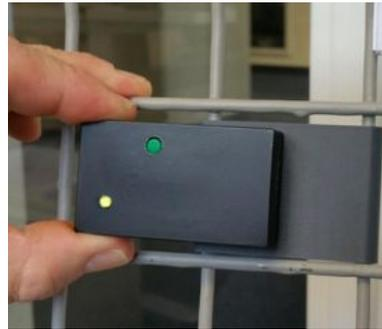
*Detektor der Fälschungssicherung am Beispiel der Gitterboxenklammer.*
